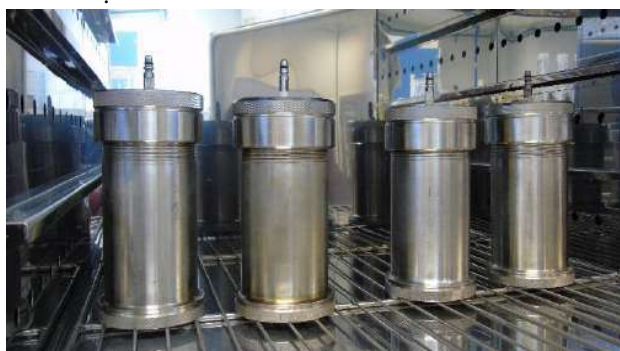
Figura 1. Exemplo de amostras condicionadas em tanques de aço para estudo de curta duração a temperatura constante.
