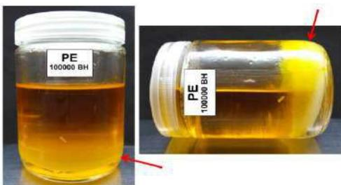
**Figura 2.** Aspecto do crescimento do fungo filamentosso na interface óleo/água (seta) na condição biodiesel com a adição de 100.000 ppm do meio mineral BH).
