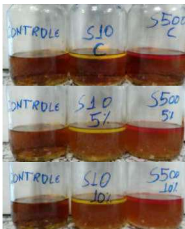
Figura 1. Suspensão bacteriana referida às amostras de diesel S10 e S500 com adição de água após 30 dias de estocagem simulada.
