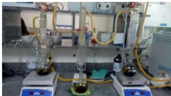
Figura 1. Sistema extrator de Soxhlet
