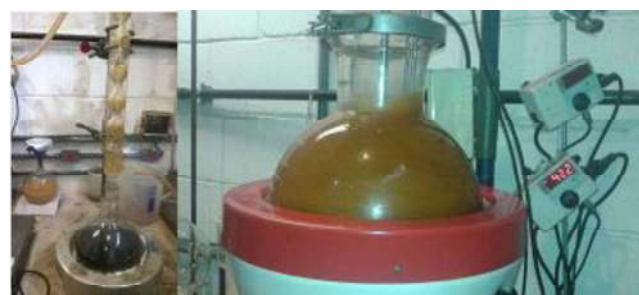
Figura 2. Esterificação Gordura de esgoto e Transesterificação do produto esterificado
