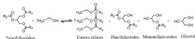
**Figura 1.** Esquema genérico de uma reação de transesterificação.
