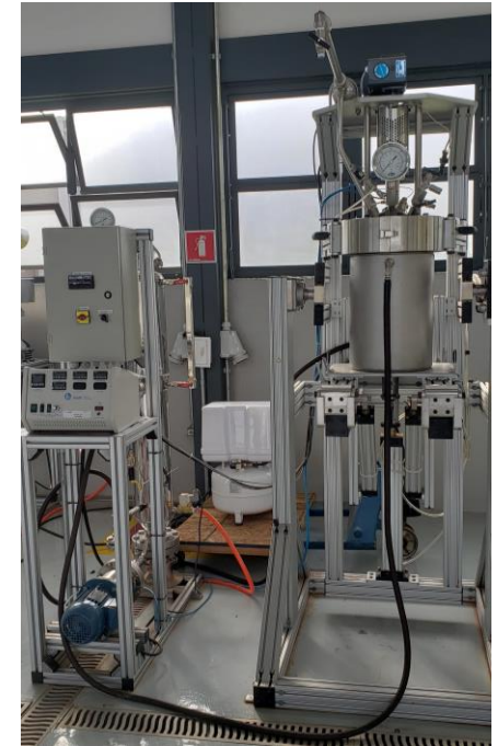
Reator de alta pressão e temperatura (18 L)
