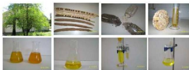
**Figura 1.** Planta e algumas biomassas obtidas das sementes da moringa<sup>4</sup>. (a) uma das moringueiras da coleta; (b) vagens maduras; (c) sementes, grãos e cascas; (d) torta e óleo de prensagem; (e) óleos brutos de prensagem (esquerda) e por solvente (direita); (f) óleo misto purificado (g) biodiesel (esquerda) e glicerina impuros; (h) biodiesel purificado.
