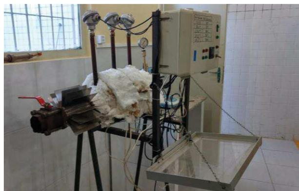
Figura 1. Gaseificador de leito fixo utilizado nos experimentos
