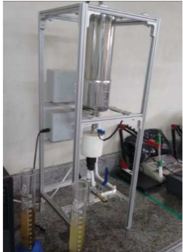
Figura 1. Aparato para reação de transesterificação do óleo de soja.
