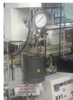
Figura 1. Reator fechado de inox com agitação mecânica.
