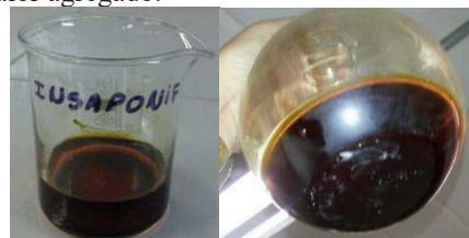
Figura 3. Fração insaponificável e biodiesel produzidos por saponificação/acidulação/esterificação.
