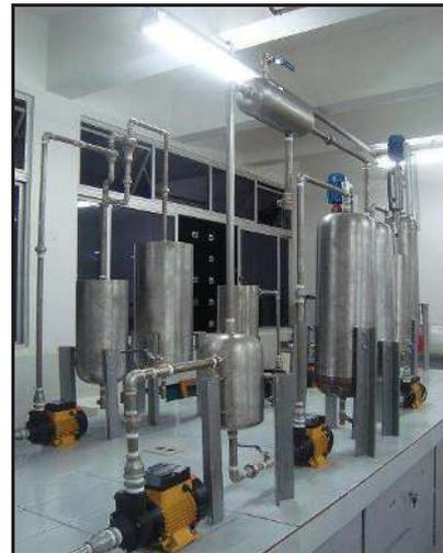
Figura 1. Unidade piloto de produção de biodiesel instalada na UNICAP-Recife
